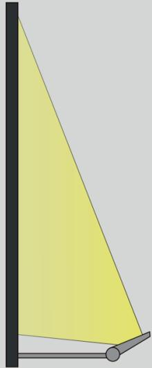
Effiziente Flächenbeleuchtung für Werbetafeln und Fassaden durch spezielles Linsendesign.
