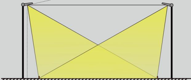
Speziell designed für gleichmässige Flächenbeleuchtung wie Sportfelder, Freiflächen und zur Minimierung von Streulicht das zur Lichtverschmutzung beiträgt
