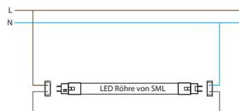
**ACHTUNG:** Beim Einbau in eine sehr alte Fassung die Röhre bitte mehrmals drehen (in beide Richtungen), das gewährleistet einen sauberen Kontakt. Stark veraltete und spröde Fassungen müssen beim Umbau getauscht werden! Sollte die LED Röhre nach dem Einbau flackern, oder nicht die volle Helligkeit erreichen liegt ein Kontaktproblem vor und es muß die Fassung getauscht werden!
